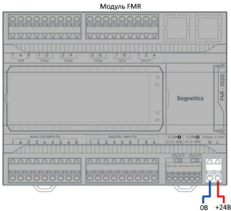
Рисунок 8 - Двухконтактный разъем питания модуля FMR
