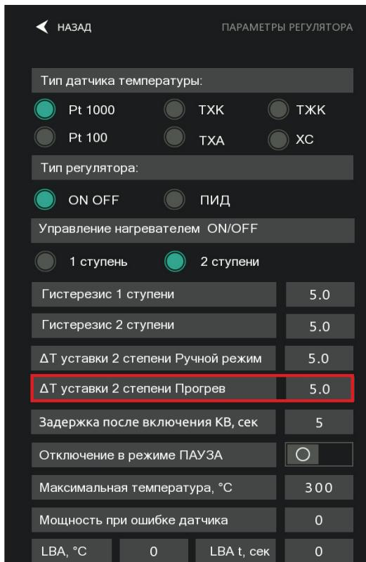
Рисунок 44 - Настройка уставки второй ступени терморегулятора в режиме прогрева
