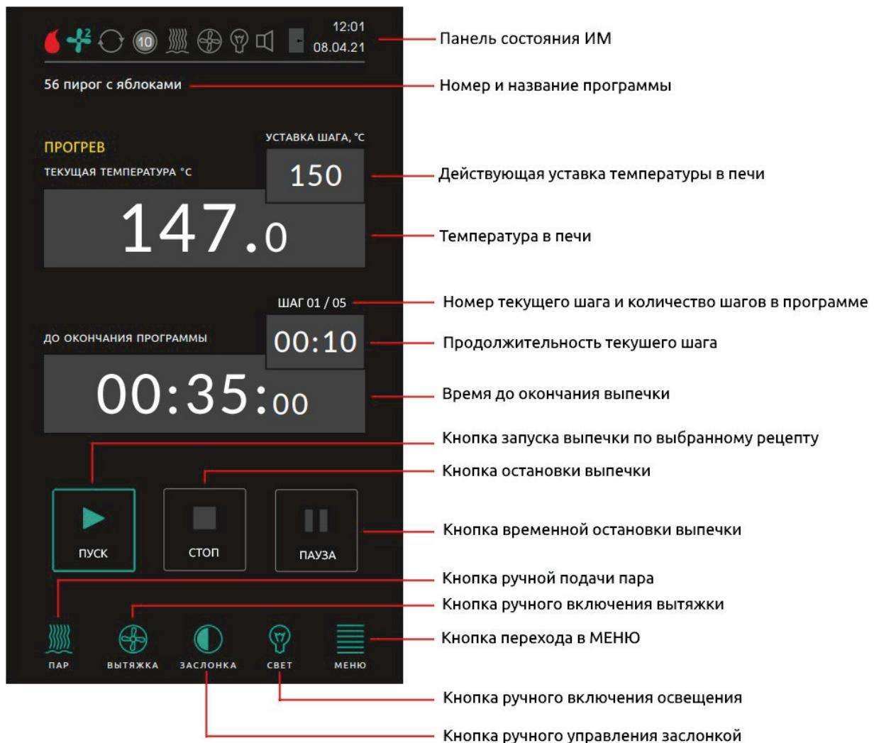
Рисунок 15- Главный рабочий экран автоматического режима работы
