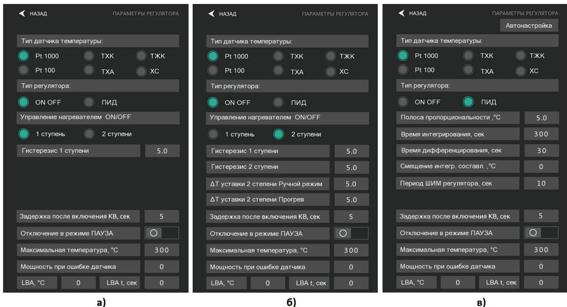
Рисунок 43 - Настройки регулятора
