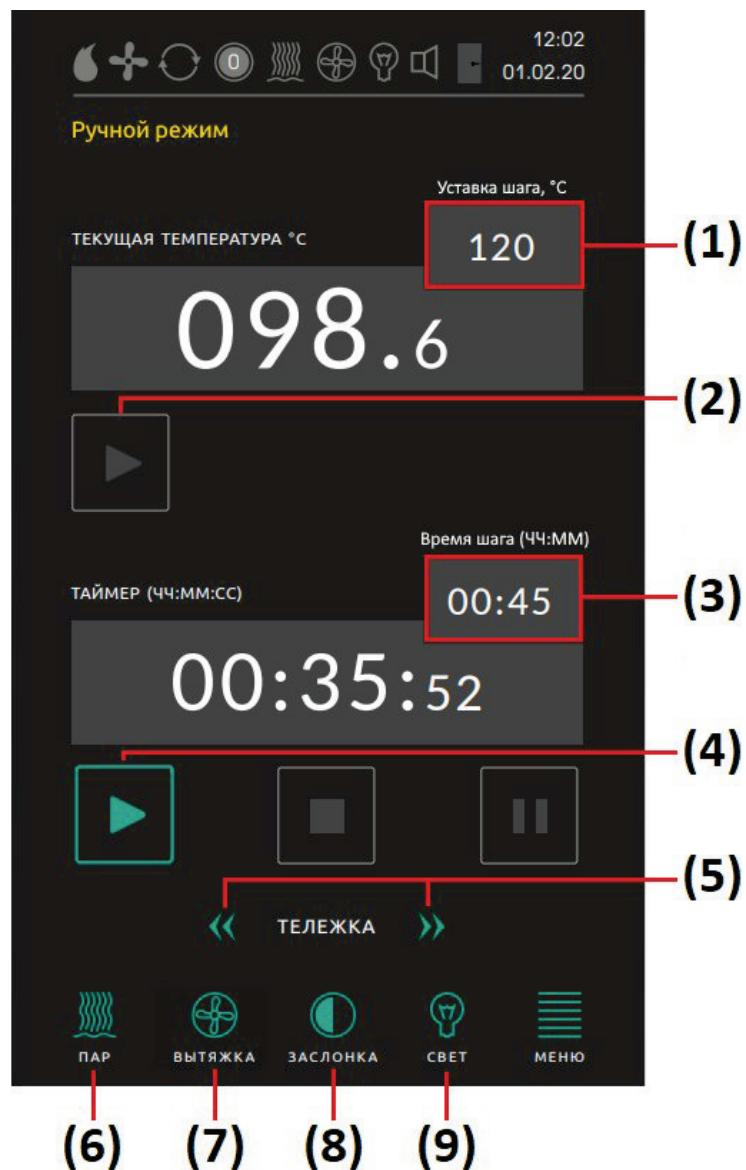
Рисунок 29- Экран полуавтоматического режима работы печи
