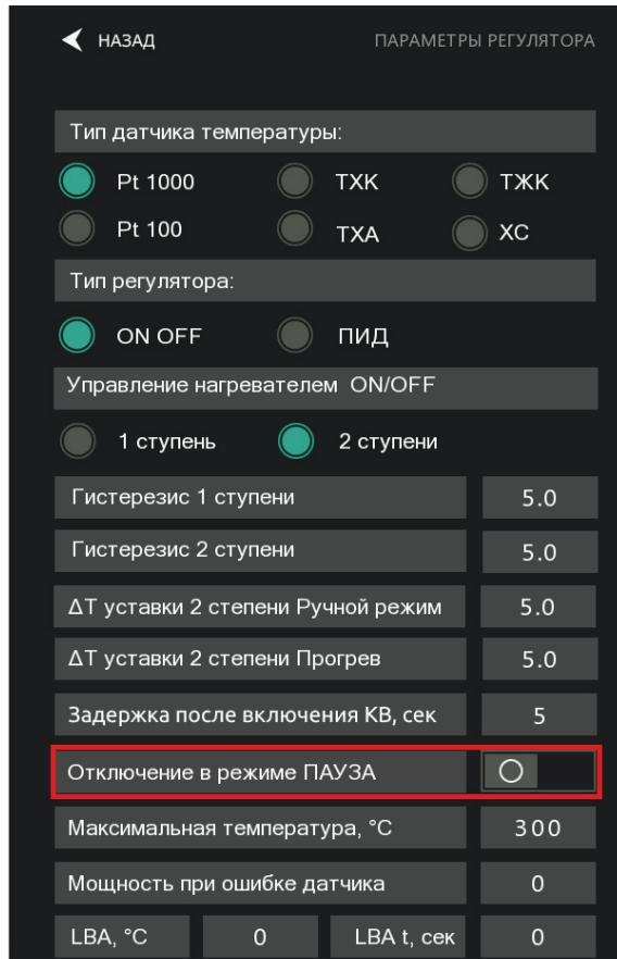
Рисунок 46 - Работа терморегулятора в трежисиме ПАУЗА
