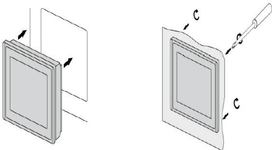
*Рисунок 5 - Установка панели в монтажное отверстие*
