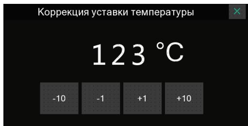
Рисунок 19 - Коррекция уставки температуры шага
