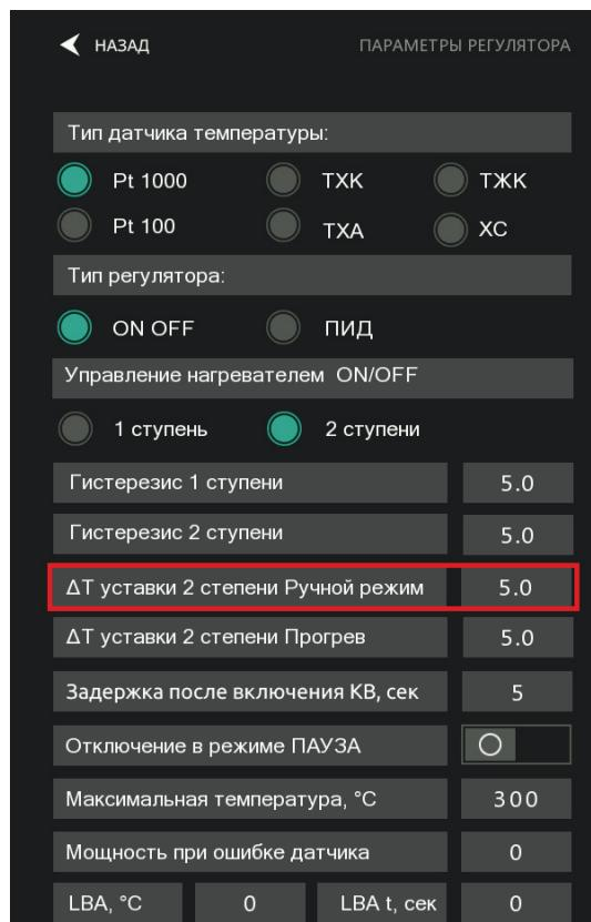
Рисунок 45 - Настройка уставки второй ступени терморегулятора в ручном режиме
