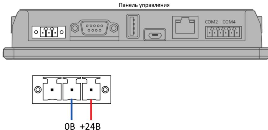
Рисунок 7 - Трехконтактный разъем питания панели управления
