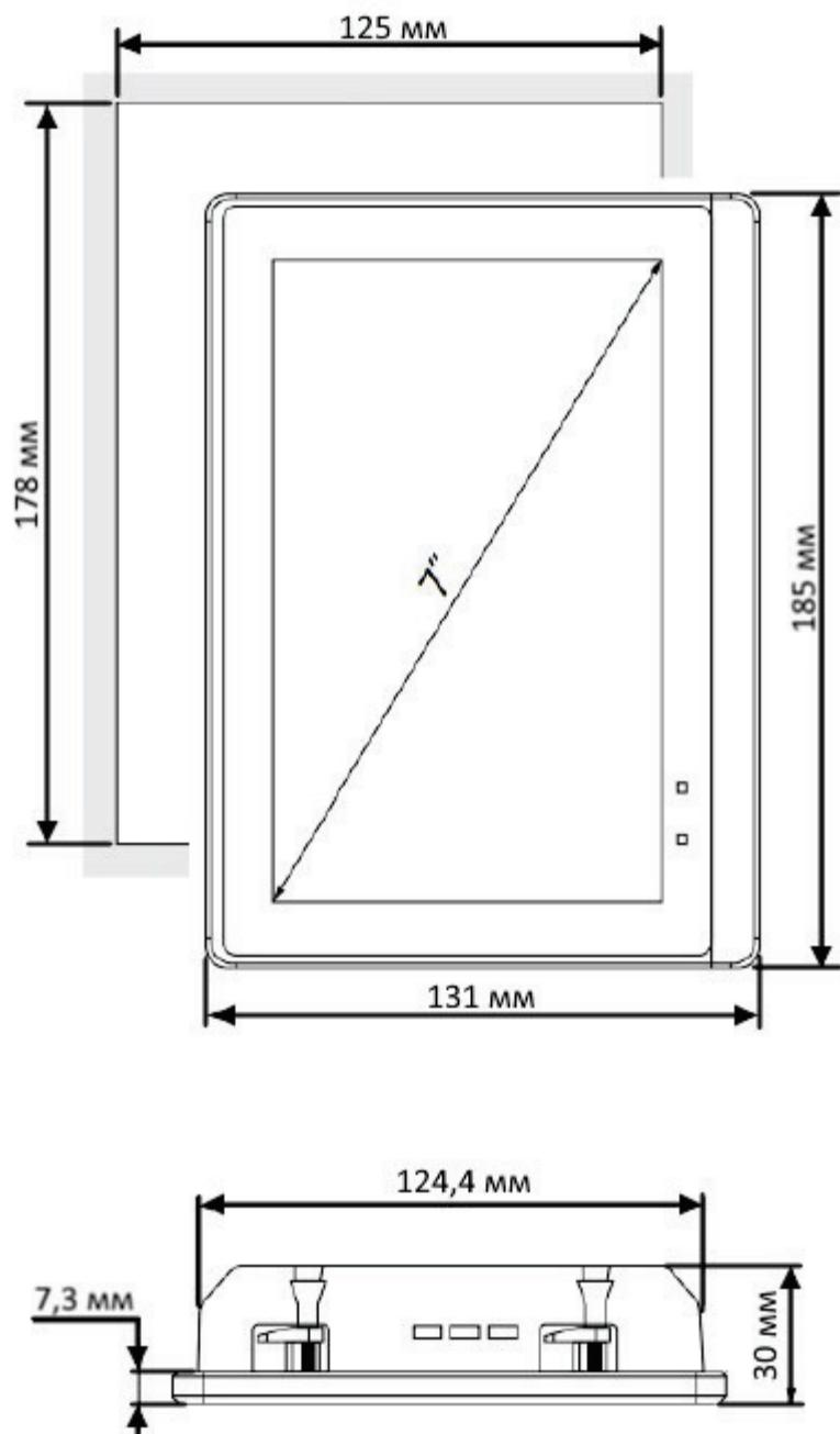
Рисунок 1 - Габаритные размеры панели управления
