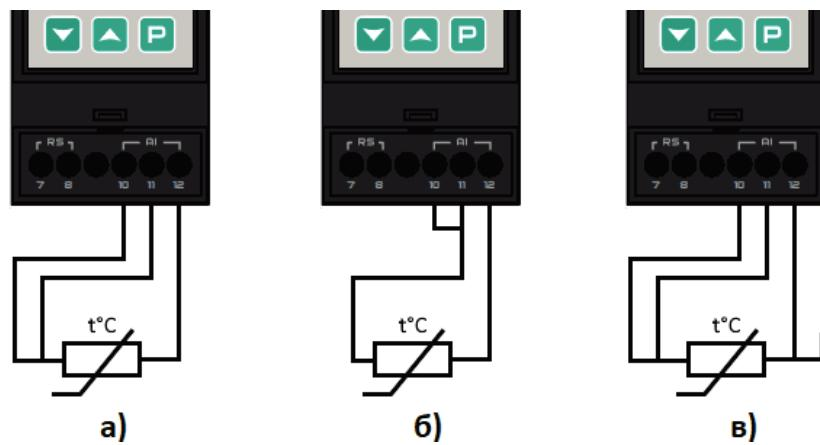
*Рисунок 13 - Подключения термопреобразователей сопротивления*
