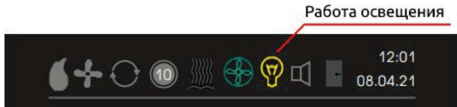
Рисунок 25 - Работа освещения
