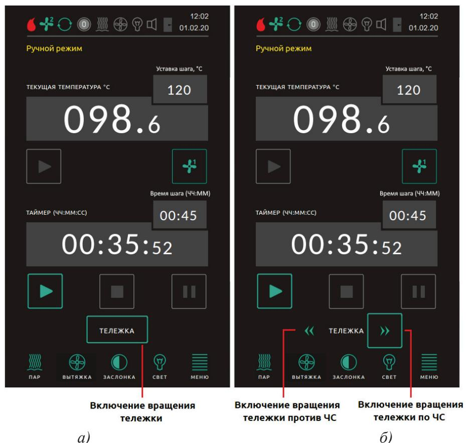
Рисунок 32 - Управление вращением тележки в ручном режиме
