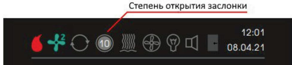
*Рисунок 24 - Отображение степени открытия заслонки*
