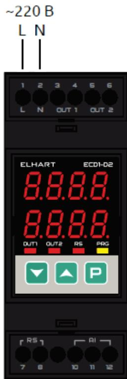
Рисунок 9 - Клеммы питания регулятора
