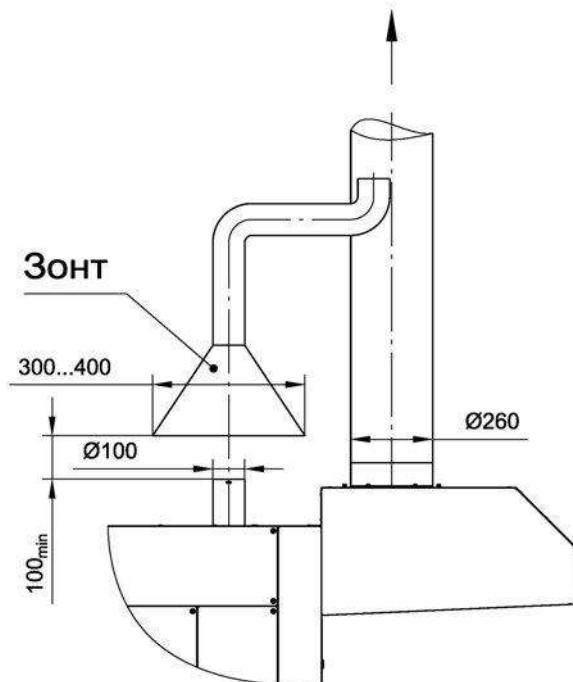
**Рисунок 7б. Совмещенная вентиляция**
